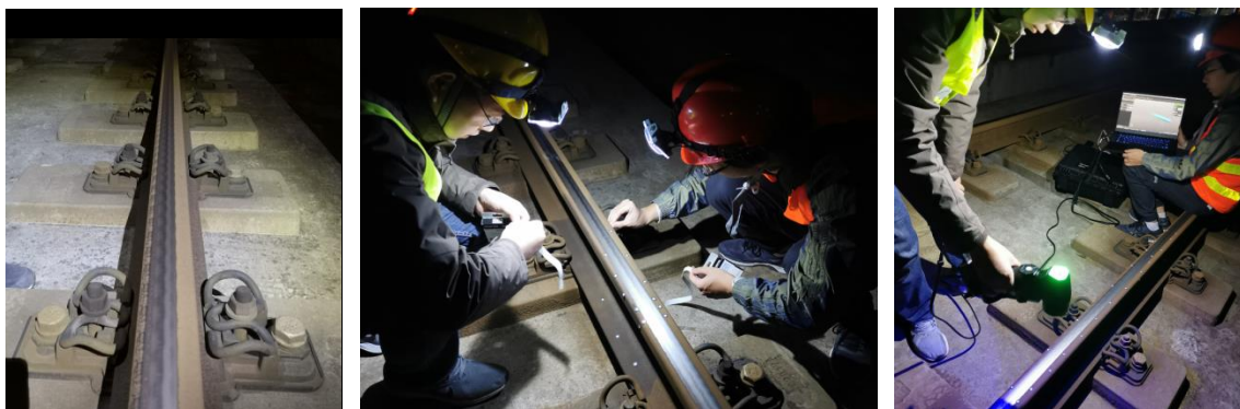
图 2.18 温州市域铁路钢轨波磨和车轮磨损状态第二次测试
