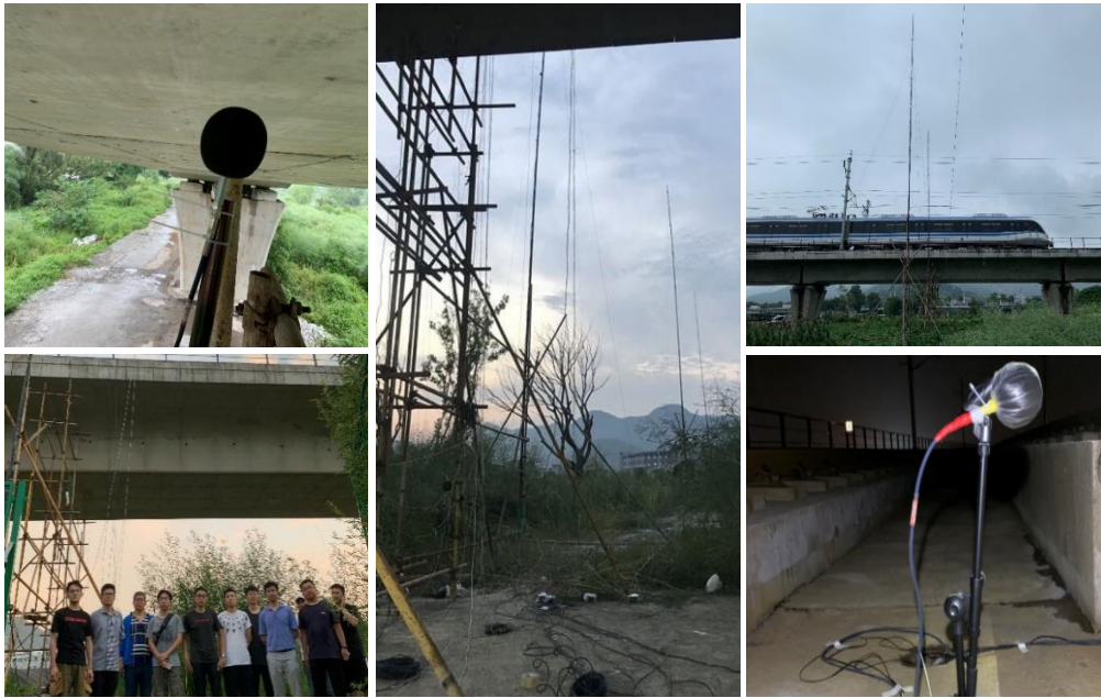
图 2.12 2020 年 9 月温州市域铁路 S1 线路桥梁振动、轮轨噪声评估
