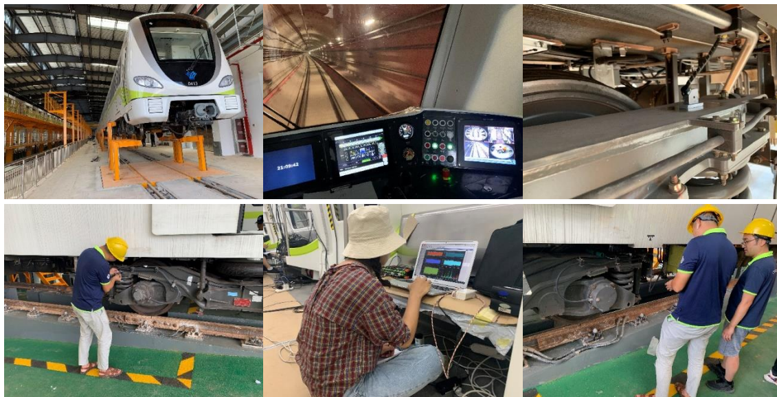
图 2.6 广西南宁地铁车辆转向架测试
