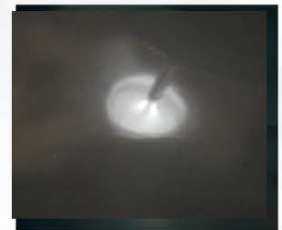
Molten weld metal
