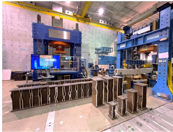
高强度 S690 和 S960 钢焊接拼接粗大柱的压缩试验
