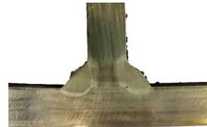
c) 腐蚀后观测到的热影响区
