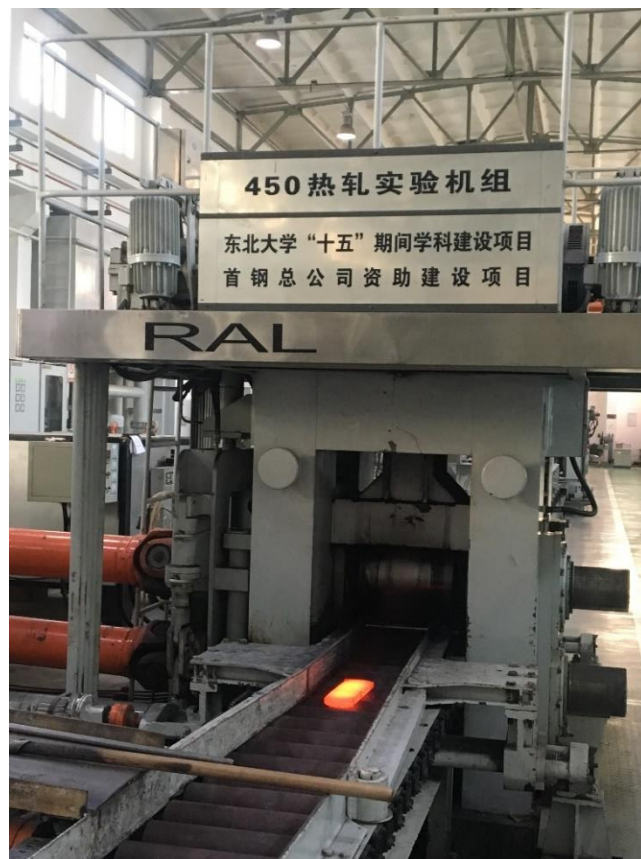
东北大学自主研发的450二辊热轧实验机
