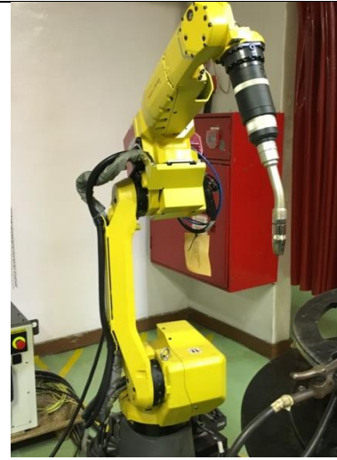
机器人焊接系统
