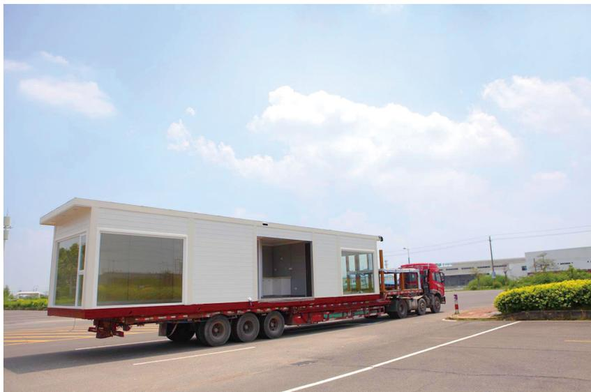
步驟一：每個房屋模塊整體在工廠預製好，通過拖車運輸到工地現場。
