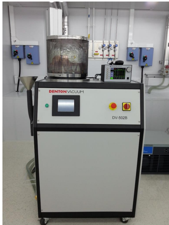
Denton DV502B Thermal Evaporator
